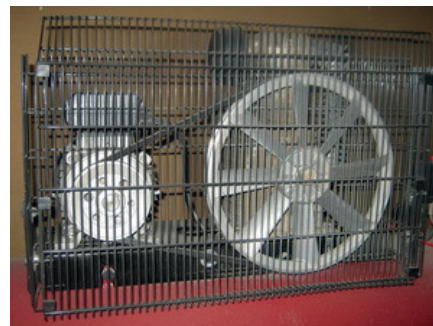
Слика 29. Заштита на електрични делови и погонски мотор
