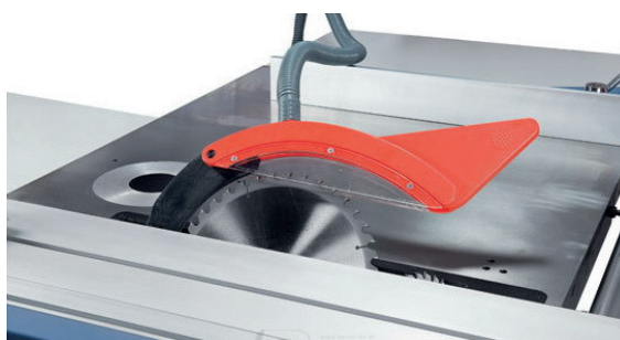
Слика 27. Заштитна капа кај кружна пила
