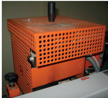
Слика 29. Заштита на електрични делови и погонски мотор
