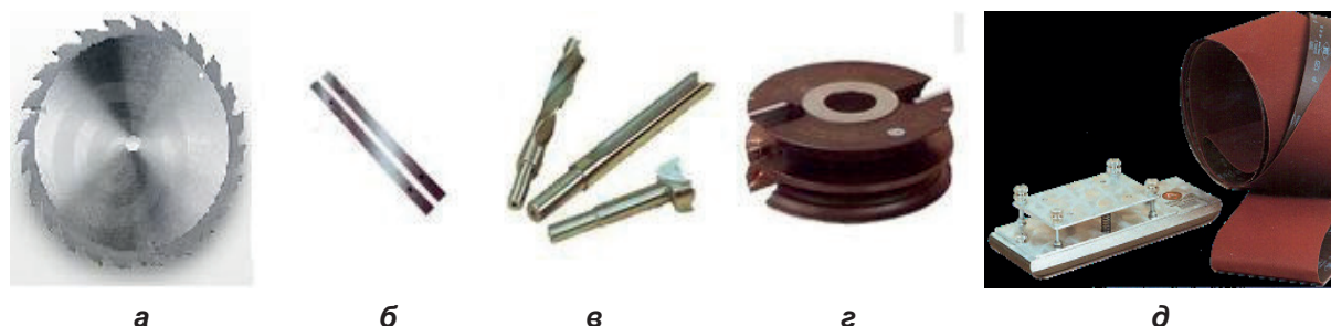
Слика 37. Типови на работни алати кај машините за обработка на дрво а-кружна пила; б-ножеви; в-бургии и длета г- глодало д-брусна хартија
